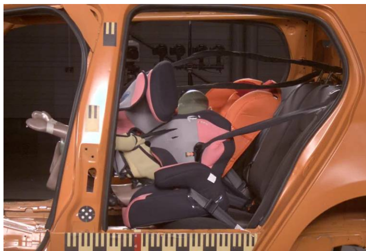
Ilustración 2: La sillita Tiggo Bebehu en el test de impacto frontal el respaldo sufre una deformación severa provocando que el asiento y el niño lleguen muy adelante.
