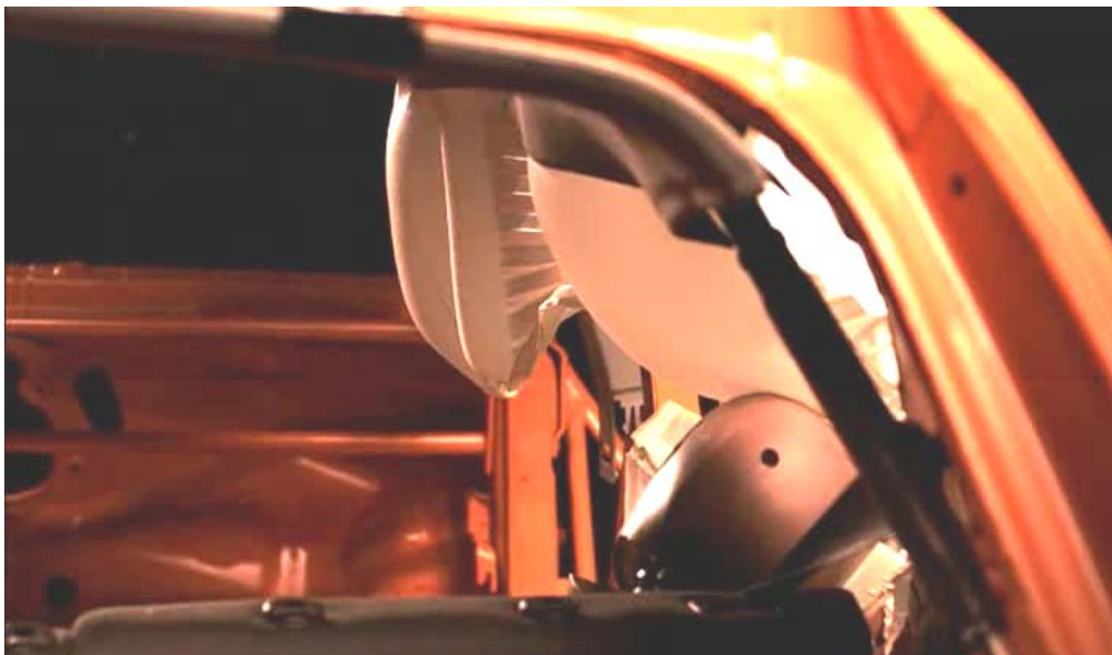
Ilustración 4: SRI sin apoyo dorsal en una prueba realizada en un vehículo con airbag de cortina. A pesar del airbag, el dummy impacta contra la puerta del vehículo
