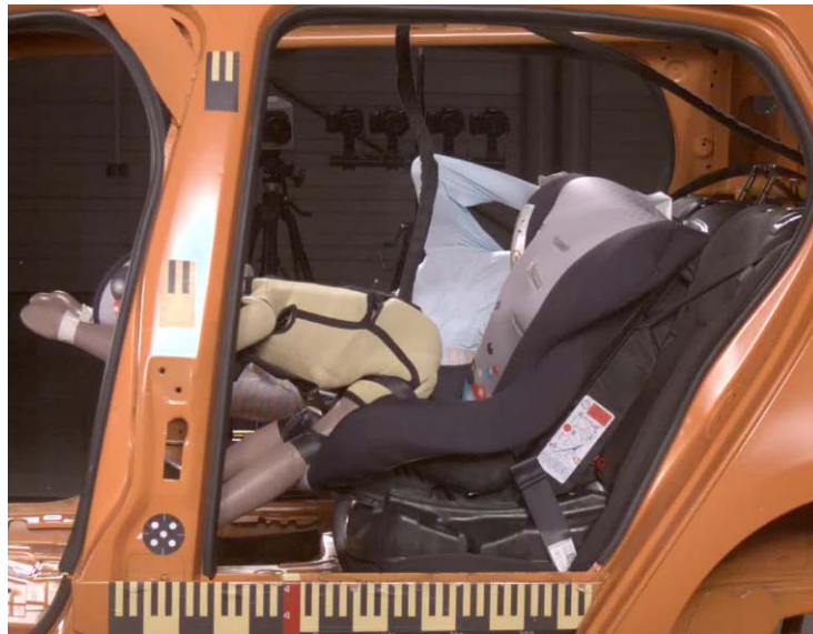
Ilustración 1: Las pruebas de impacto frontal realizadas a la Nania Safety Paris resultan en que las correas superiores se desgarran y se saltan de la silla infantil y la cabeza del dummy se dispara hacia delante.
