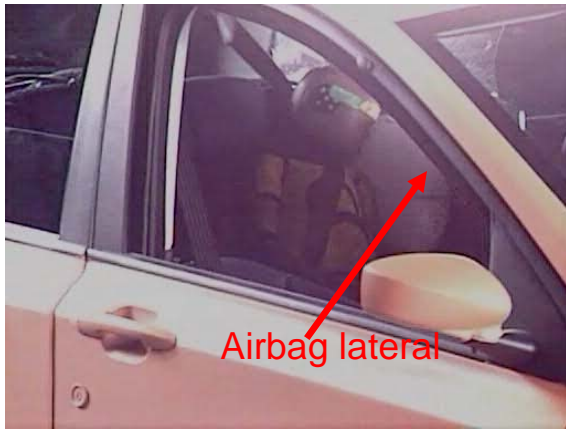
Ilustración 5: SRI sin soporte dorsal en una prueba realizada en un vehículo con airbags laterales y de cortina
