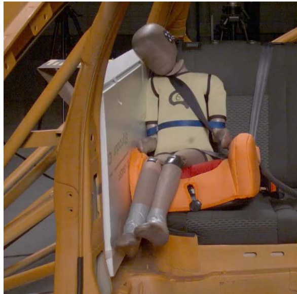
Ilustración 3: Asiento elevado sin soporte dorsal durante una prueba de impacto lateral. La cabeza y el pecho del dummy (Q6) quedan sin protección e impactan fuertemente contra la puerta del vehículo.
